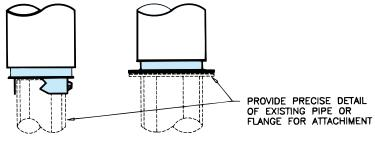
SPECIAL DIAMETER SEAL RING SPECIAL FLANGE ADAPTER
